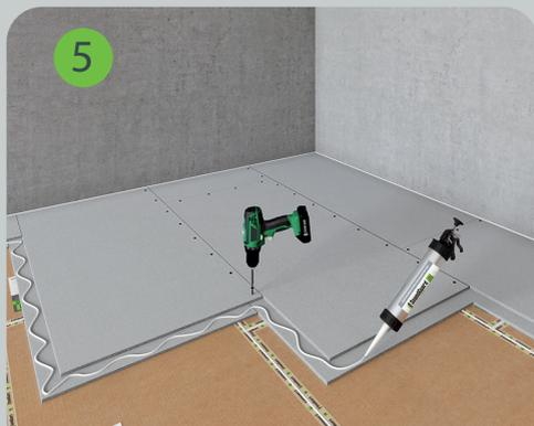
В процессе монтажа элементов пола KNAUF Суперпол или аналога места соединения листов заполняются звукоизоляционным герметиком SoundGuard Seal. Листы соединяются между собой саморезами длиной не более 20 мм.
